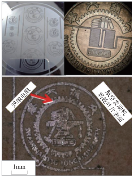
图9 在涡轮叶片上制备的薄膜RTD
